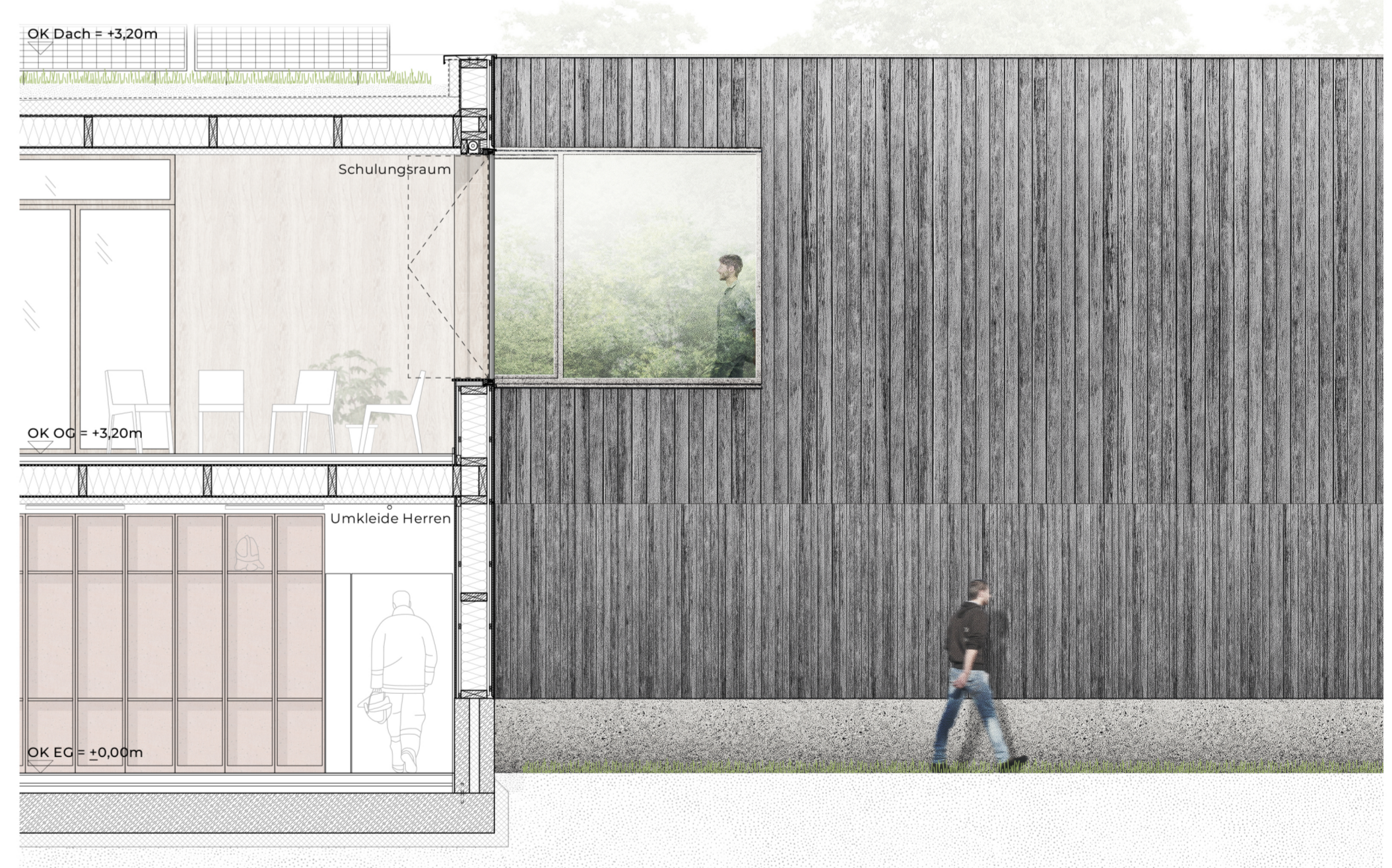
Fassade Ansicht & Schnitt 1:50
